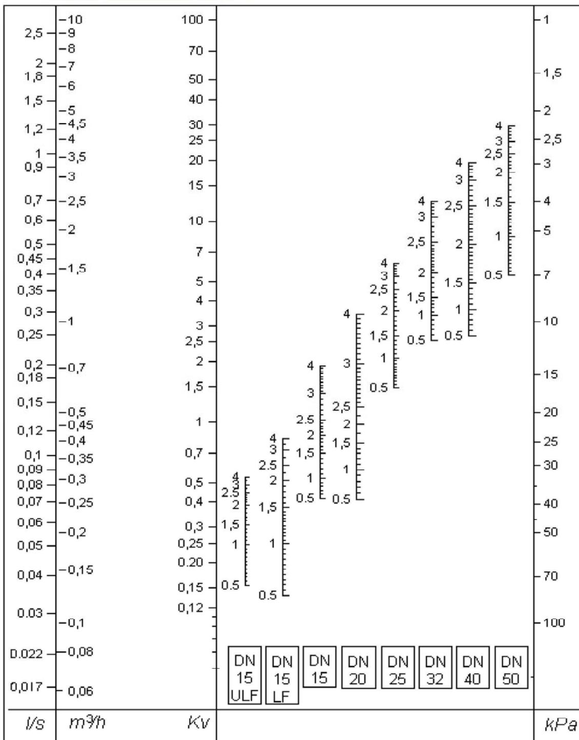
Data la portata e la perdita di carico di progetto é possibile stimare la posizione di prerregolazione della valvola attraverso la tabella sopra:
