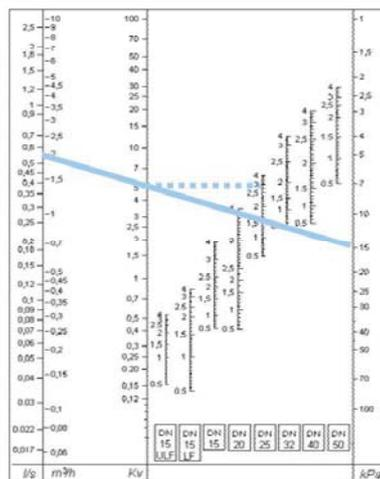
Nell'esempio per portata di progetto 2 m<sup>3</sup>/h e  $\Delta p$  15kPa risulta per una valvola DN25 una regolazione volantino di 2,9
