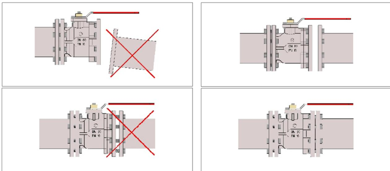
Assicurarsi che l'impianto sia dotato di giunto di espansione al fine di evitare rotture o perdite.
