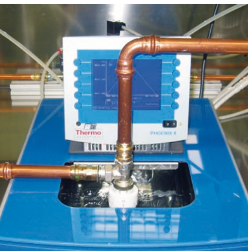
Station für Abnahmetests der Thermostatköpfe
